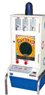
'89 タイター エメラルドホール 8 人用のルーレットゲーム。オッズテーブルはモニターで表示し、プレイヤーはトラックボールを使ってベットしていく。 © TAITO CORP. 1989
