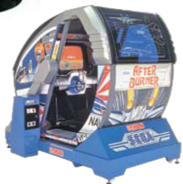
'87 セガ・エンタープライゼス アフターバーナー II 大空を舞台にドッグファイトを繰り返すフライトシミュレーション。二軸回転方式の大型可動筐体を採用しており、画面上の自機の動きに合わせて筐体が前後左右に可動する。 © SEGA
